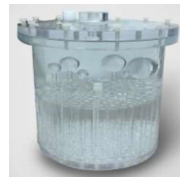
Figura 2.5.7. Maniquí SPECT para acreditación ACR (Jaszczak Phantom). Se compone de un cilindro con diámetro de 20.4 cm y altura de 18.6 cm, los insertos tipo barra (seis conjuntos de barras) tienen diámetros de 4.8, 6.4, 7.9, 9.5, 11.1 y 12.7 mm cada uno y los insertos tipo esfera (seis) tiene diámetros de 9.5, 12.7, 15.9, 19.1, 25.4 y 31.8 mm respectivamente.
