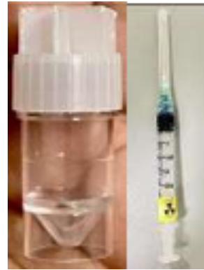
Figura 2.5.2. El vial con punta en V para formar la fuente puntual, o jeringa de poco volumen (máximo 3 ml) a gran distancia para que el equipo detecte como fuente puntual.
